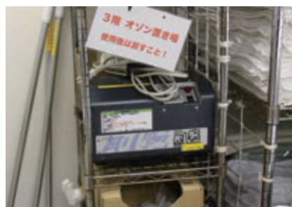
客室清掃の仕上げとしてオゾン脱臭機を使用
