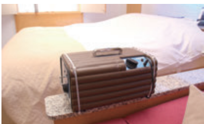
客室清掃終了後、オゾン発生器で客室空間の除菌
